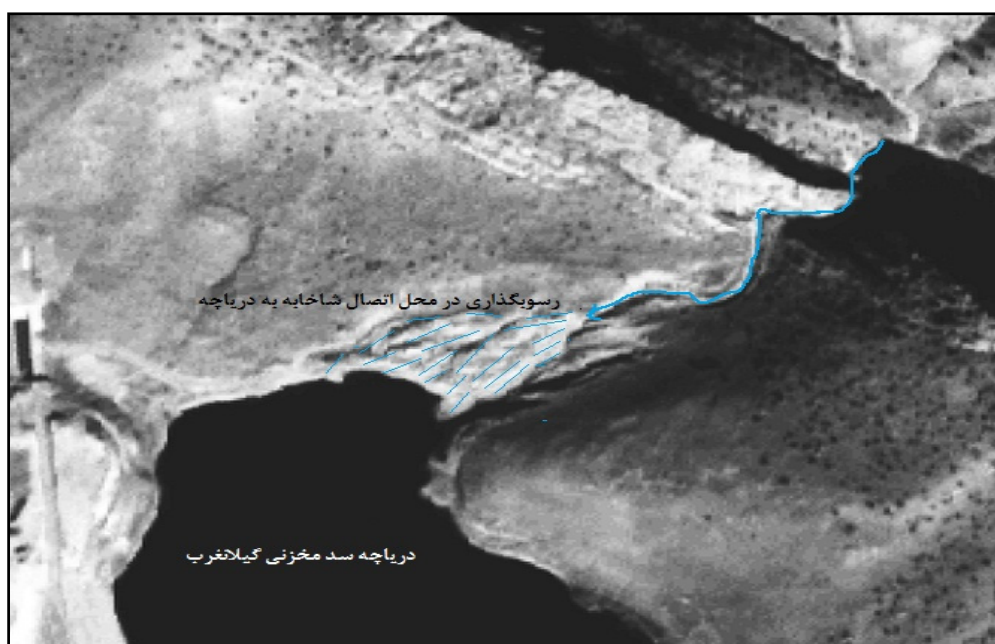
شکل ۵. رسوب‌گذاری در محل اتصال یکی از شاخه‌ها به دریاچه سد، تحت تأثیر بالآمدن سطح اساس محلی (منبع: تصویر ماهواره‌ای IRS-P5)
